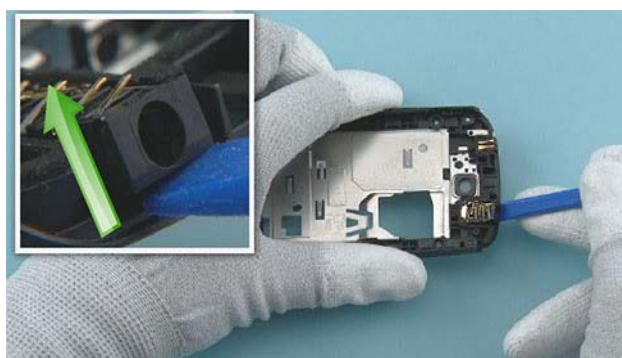
28) Use the SS-93 to lever out the AV JACK.
