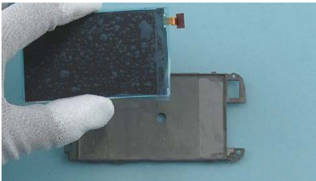
21) Separate the DISPLAY and the UI FRAME.
